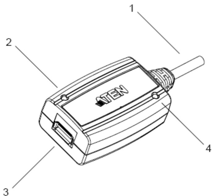
1. 内建配有连接 USB 到主机 USB 端口或插孔的线缆
